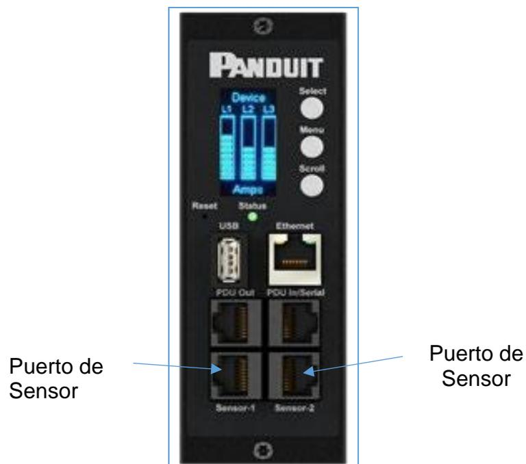
**Figura 90: Puertos de Sensor en el Controlador**
