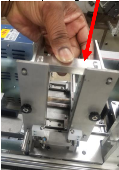
Figure 21 Chargement de plaques de 3,5" (89 mm) de large
