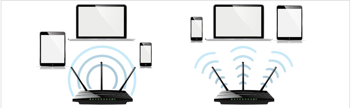
Figura 3. Ejemplo de conformación de haces con un flujo de datos espacial (izquierda) y tres flujos de datos espaciales (derecha)<sup>3</sup>.
